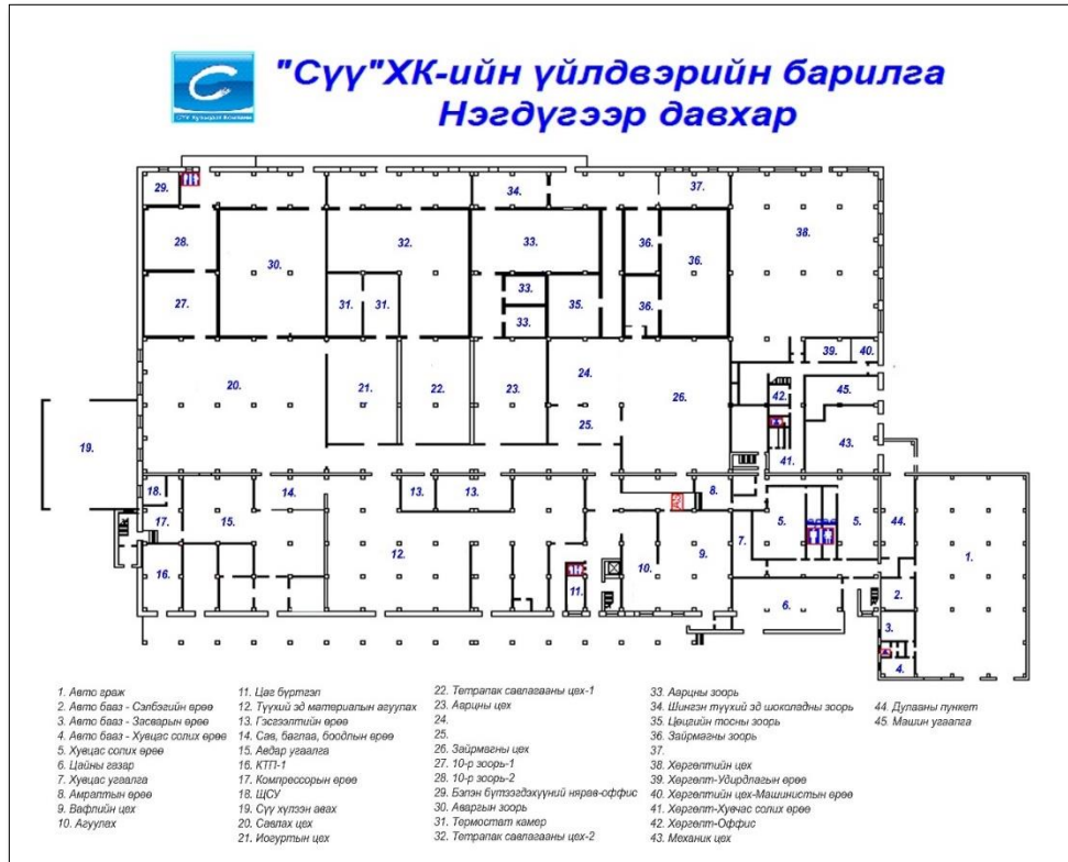
Зураг 1. 3. Үйлдвэрийн барилгын 1-р давхарын зохион байгуулалтын схем зураг
