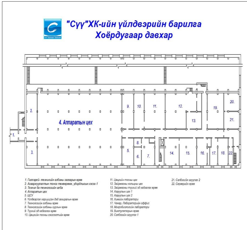
Зураг 1. 5. Үйлдвэрийн барилгын 2-р давхарын зохион байгуулалтын схем зураг
