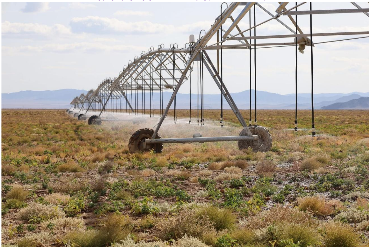
Зураг 4. 269га талбайг услах төвийн эргэлттэй 5ш бороожуулах машин
