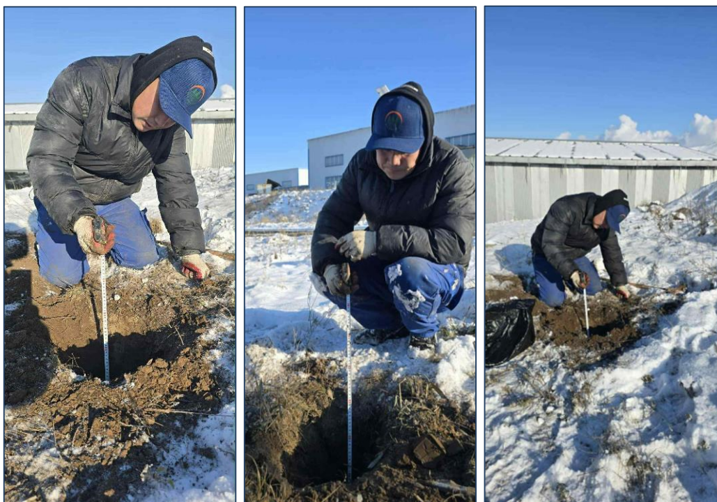
Зураг 16. Хөрсний зүсэлт хийж, дээж авч буй байдал
