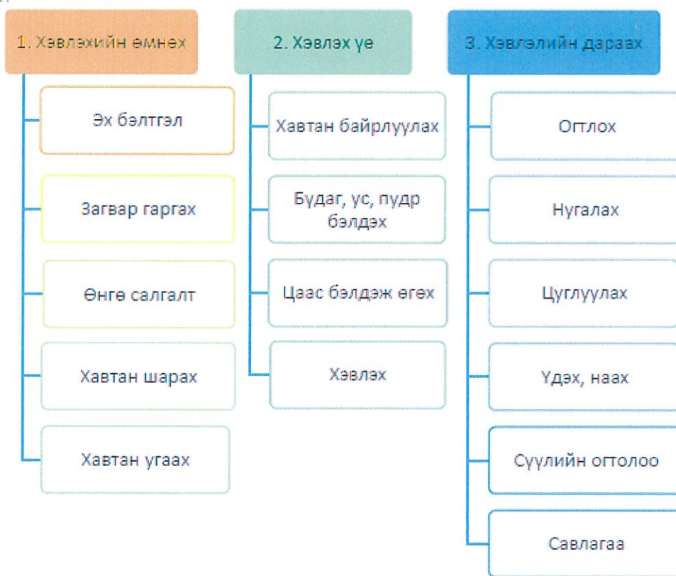
Зураг 5. Хэвлэх үйлдвэрлэлийн технологийн схем
