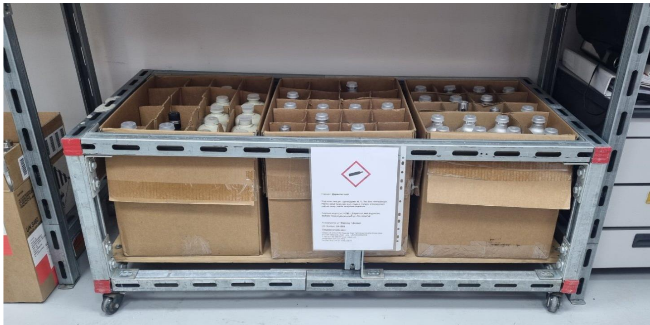
Зураг 6. Унах гэмтэхээс хамгаалсан төмөр хийцлэлтэй хамгаалалтын хайрцагт байршуулдаг байдал
