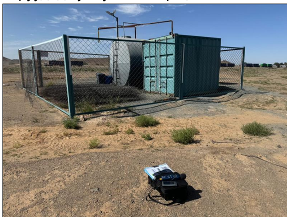
Зураг № 39. Дуу чимээний хэмжилт хийж буй байдал
