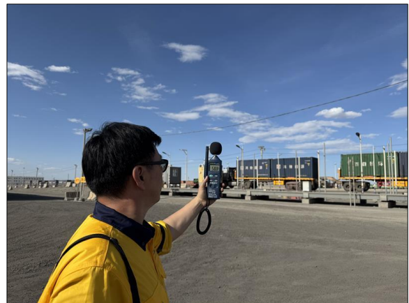
Зураг № 39. Дуу чимээний хэмжилт хийж буй байдал
