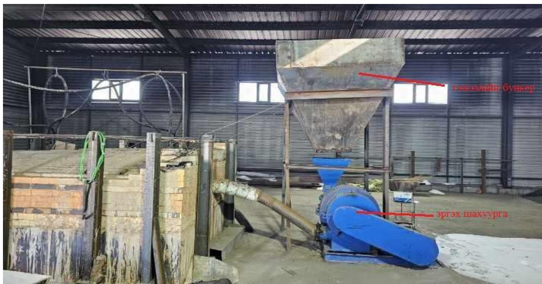
Зураг 9. Тэжээлийн бункер, зууханд тэжээл өгөх эргэх араат шахуурга
