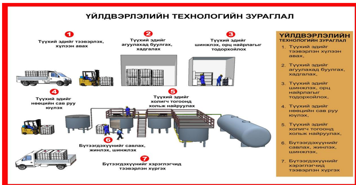
Зураг 8. Бетон зуурмагийн нэмэлтийн үйлдвэрийн технологийн схем
