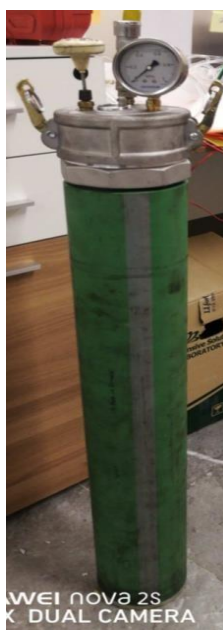
Зураг 4. Тэлмэн Ресурс ХХК-ийн угсарсан PQ хэмжээтэй лабораторын зориулалттай ашиглах бортого
