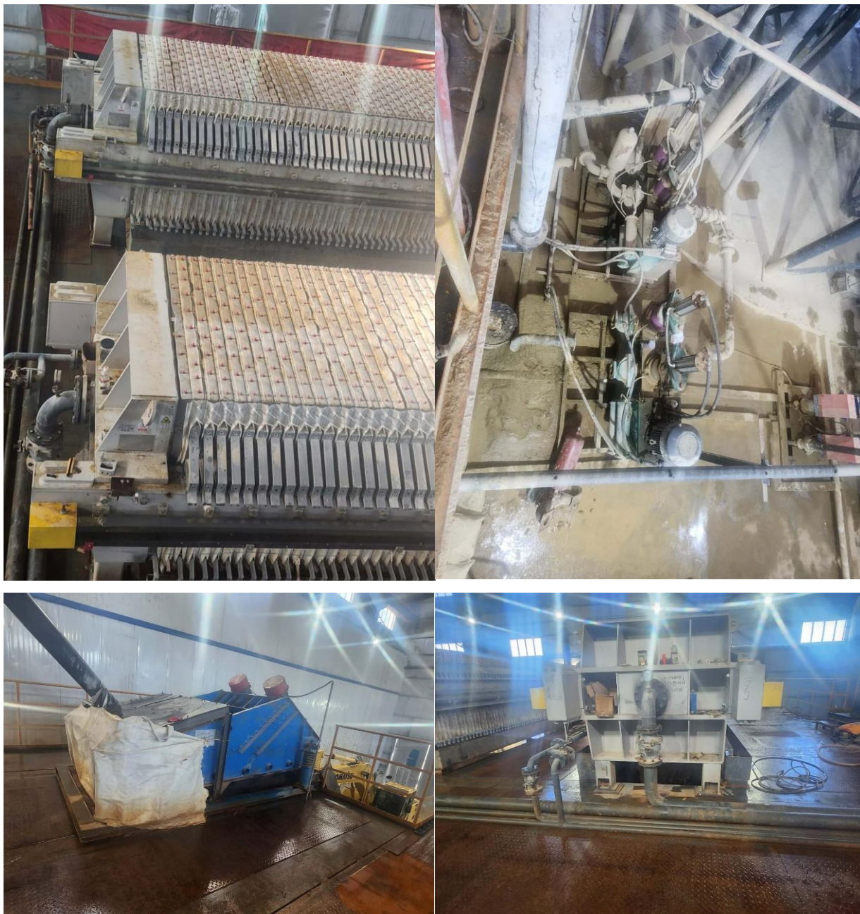
Зураг 5. Баяжуулах үйлдвэрт хийсэн хаягдлыг усгүйжүүлэх фильтр
