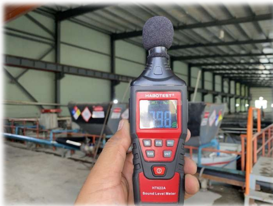
Зураг 125. Баяжуулах үйлдвэр доторх дуу чимээний хэмжилт хийж байгаа нь
