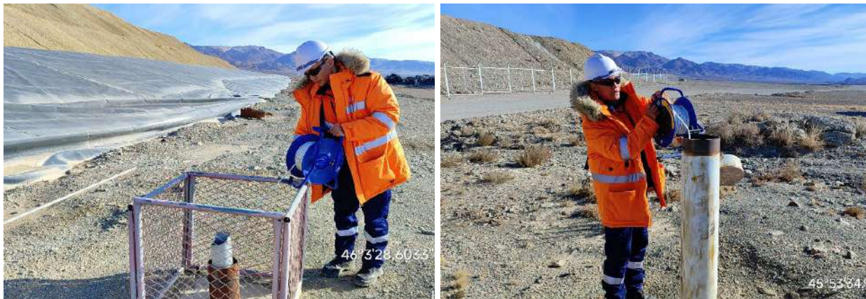
Зураг 31. Нуруулдан уусгах байгууламжийн тизометрийн цооногийн хяналт
