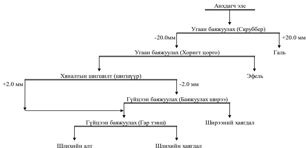
Зураг 7. Элс угаан баяжуулах технологийн схем
