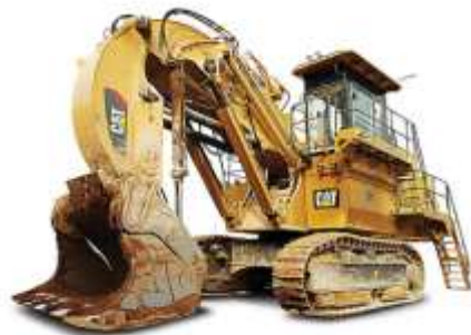
Хөрс хуулалтад ажиллах CAT 6018 FS загварын экскаватор
