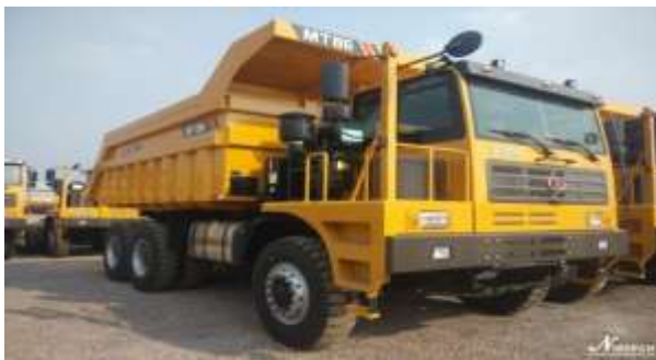
Хөрс ,нүүрс тээвэрт ажиллах LGMG MT-86 маркийн автосамосвал
