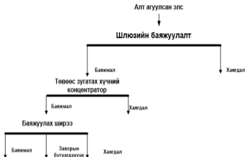
Зураг 2. “Баруун сайрын ам” алтны шороон ордын элсийг баяжуулах технологийн схем
