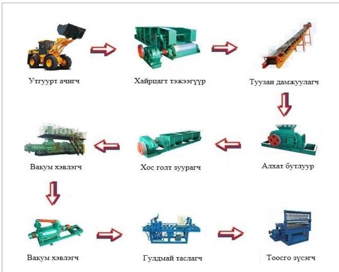
Зураг 2. Тоосго үйлдвэрлэлийн тоног төхөөрөмжийн дамжлага схем
