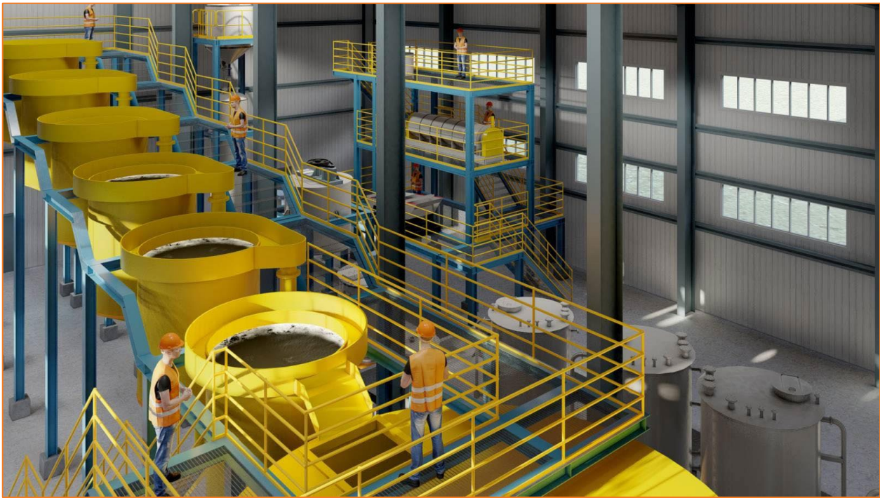
Зураг 15. Нүүрсэнд алт шингээх танкны хэсгийн 3D эскиз зураг
