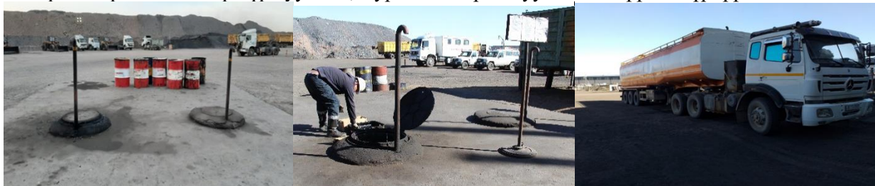
Зураг 10.2.2. Засварын төвүүдийн хаягдал тос цуглуулах танкнууд болон тос хүлээн авдаг техник
