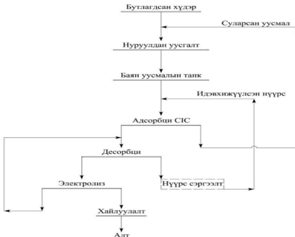
Схем 3. Нуруулдан уусгалт-CIC үйлдвэрийн технологийн схем
