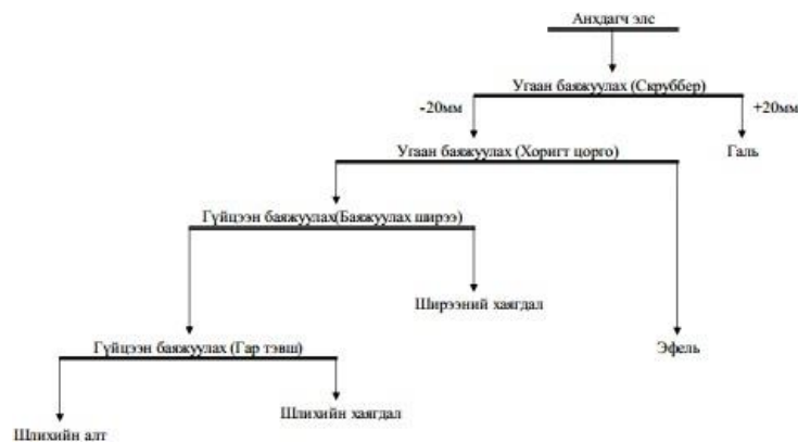
Зураг 2. Алт агуулсан элсийг угаан баяжуулах технологийн схем
