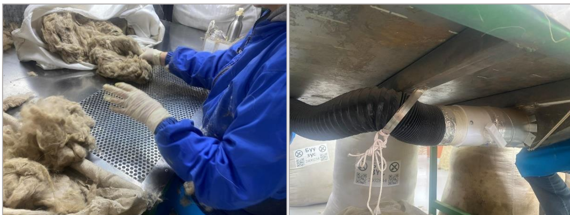
Зураг 15. Ноолуур ангилах ширээнээс тоос сорон зайлуулах систем
