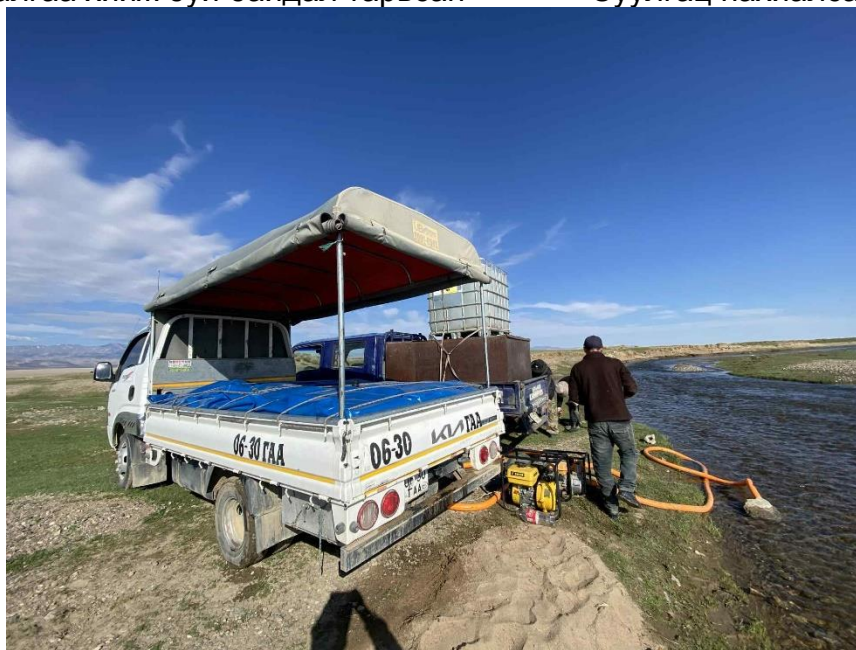
Мод услах усыг Завхан голоос татаж буй байдал
