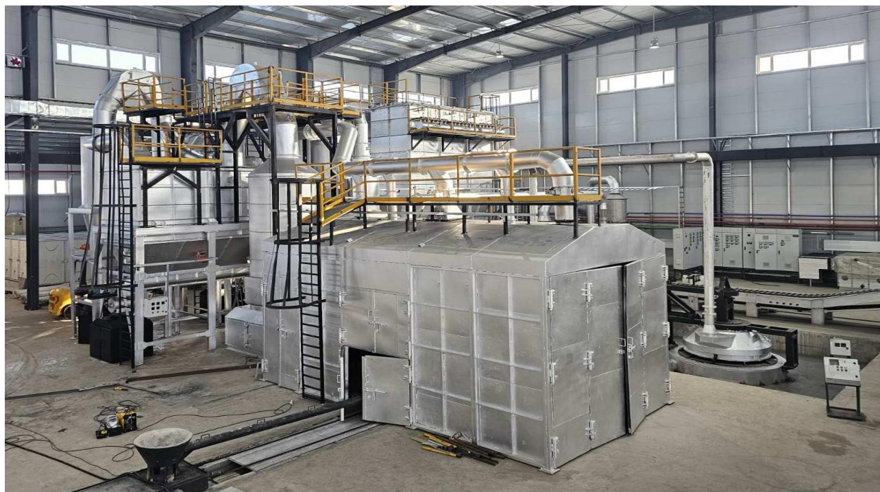
Зураг 13. Хоёр шатлалт десульфатацн бүхий пирометаллургийн технологи бүхий хайлуулах цехийн тоног төхөөрөмж
