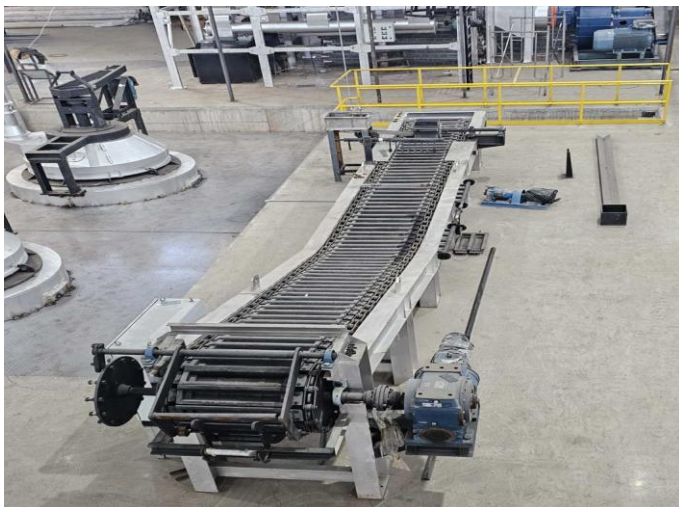
Зураг 16. Хар тугалгын гулдмайг цутгах тоног төхөөрөмж болон бүтээгдэхүүний цэвэршилтийг хэмжих spectro тах төхөөрөмж
