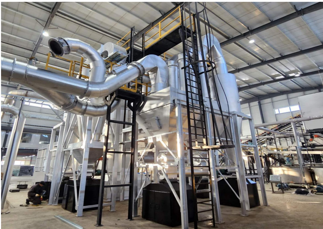
Зураг 15. Долоон үе шатаар утааг шүүн цэвэршүүлж, стандартад нийцсэн хийг агаарт нийлүүлэх бүрэн автомат тоног төхөөрөмж
