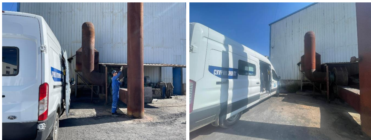
Зураг 20. Уурын зуухны яндангаас ялгарах бохирдуулагчийн хэмжилт хийж буй байдал
