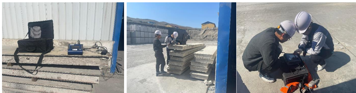
Зураг 21. Үйлдвэрийн гадна орчны агаарын чанарын хэмжилт хийж буй байдал
