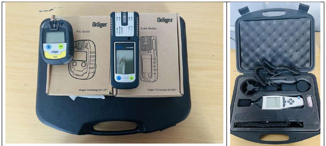
Зураг 2-3. Хий хэмжигч багажууд / Dräger Pac® 8500 болон Dräger X-am 2500/, Хэмжилтийн багаж / дуу шуугиан, гэрэл, салхины хурд, температур, чийг/
