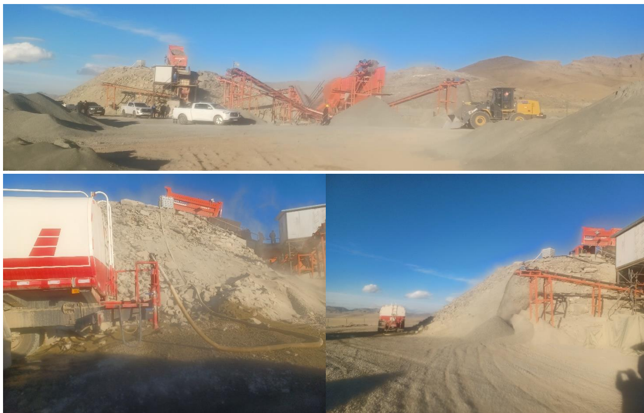
Зураг 5. Бутлуурын үйлдвэр, тоосжилтыг буурах зорилгоор бороожуулах процесс
