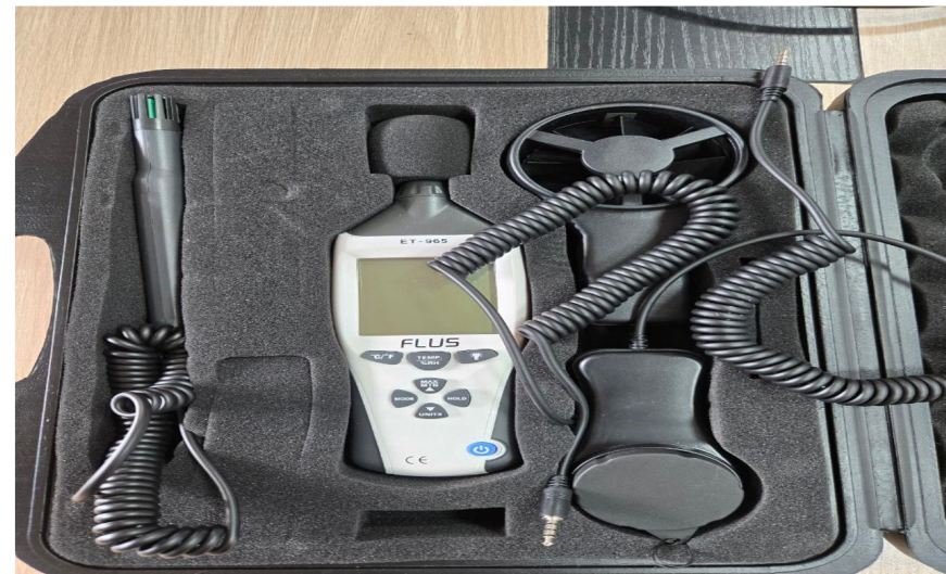
Зураг 18. Ажлын байрны хөдөлмөрийн нөхцлийн хэмжилт хийх багаж
