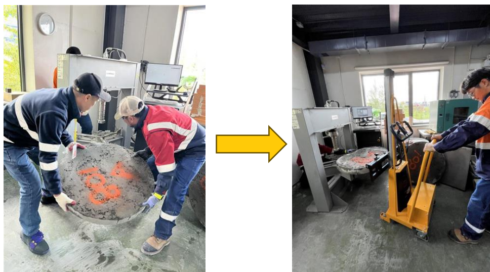
Зураг 3-23. RDP бетоны сорьц өргөх, зөөх цахилгаан өргүүр ашиглаж эхэлсэн байдал
