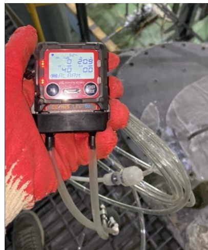
Зураг 3-62. Дотор орчин болон хязгаарлагдмал орчны агаар хэмжих багаж
