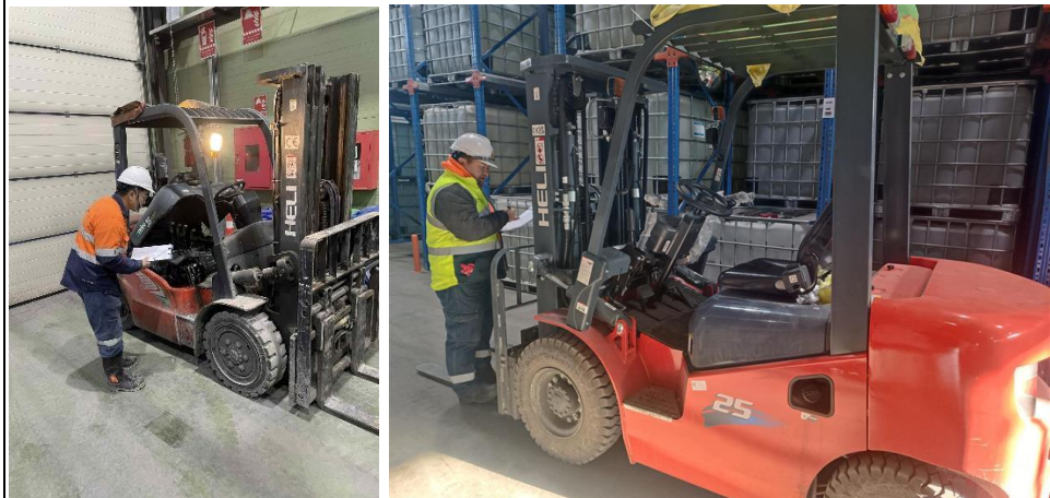
Зураг 3-59. Сэрээт өргөгчийн үзлэг шалгалт хийж буй байдал
