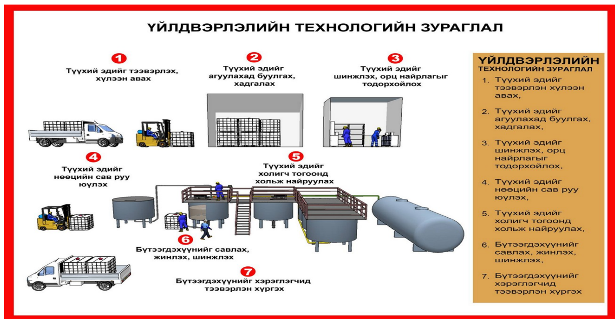
Зураг 8. Бетон зуурмагийн нэмэлтийн үйлдвэрийн технологийн схем
