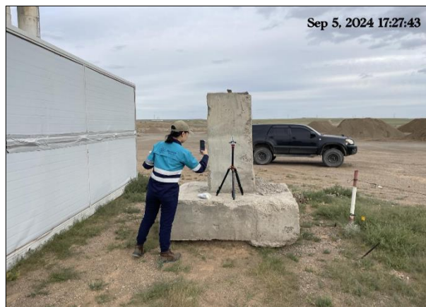
Зураг № 43. Гадаад орчны агаарын найрлага дахь SO 2 , CO, NO 2 хийнүүдийг хэмжилт хийж буй байдал
