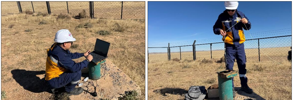
Зураг № 10. Автомат түвшин хэмжигчийн дата мэдээллийг авч буй байдал
