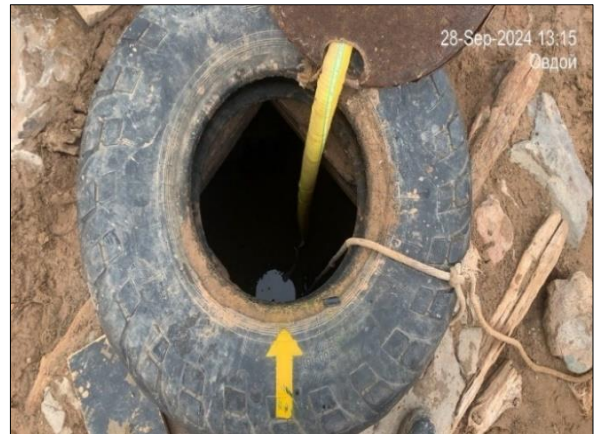
Зураг № 12. Малчны худагийн усны түвшний хэмжилт хийж буй байдал
