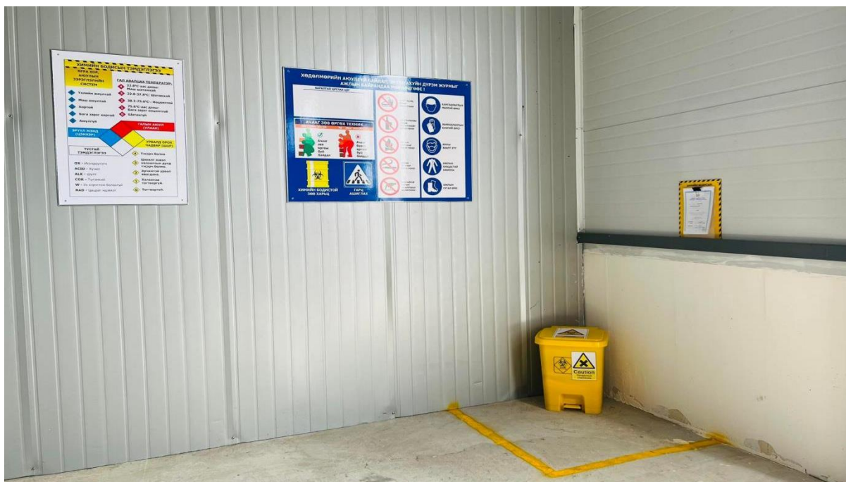
Зураг 8. Агуулахын дотор байрлуулсан тэмдэг тэмдэглэгээ, асгаралтын иж бүрдэлүүд
