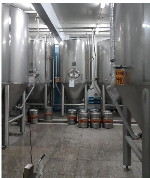
Зураг 4. Шар айргийн исгэлт барилтын 24 ширхэг танк, нийт 5000 литр багтаамжтай
