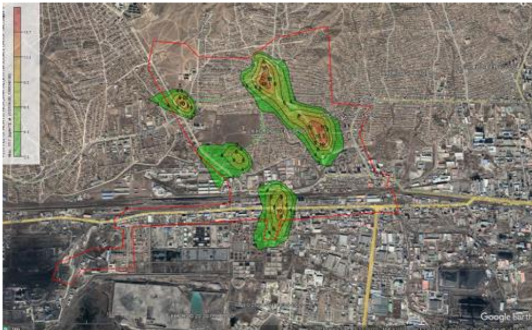
Зураг 10. Бохир усны шугамын барилгын ажлын үед үүсэх тоосны 24 цагийн дундаж агууламж
