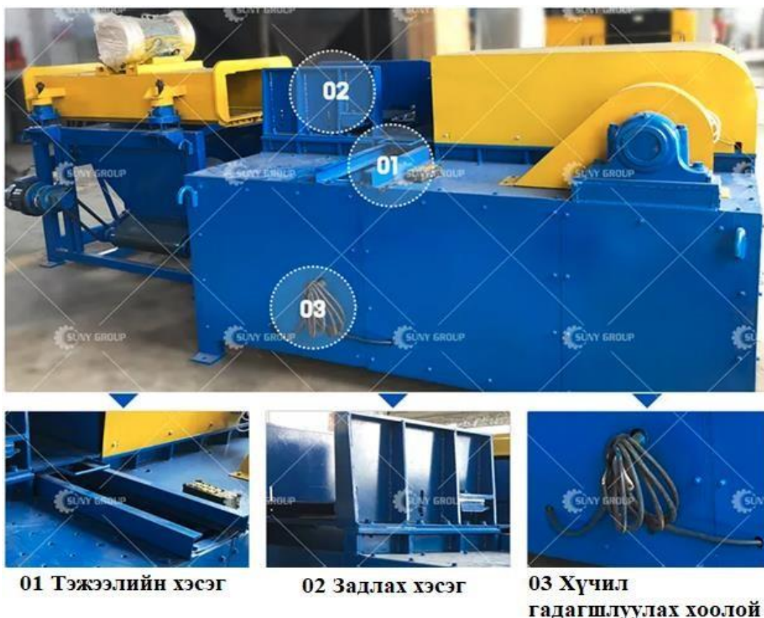
Зураг 5. Хаягдал аккумулятор задлах машин. Тэжээл, задлах хэсэг, хүчил гадагшлуулах хоолойн ерөнхий бүтэц
