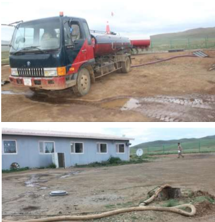
Зураг 18 Ахуйн бохир усыг хуримтлуулах танк болон бохир соруулж буй байдал
