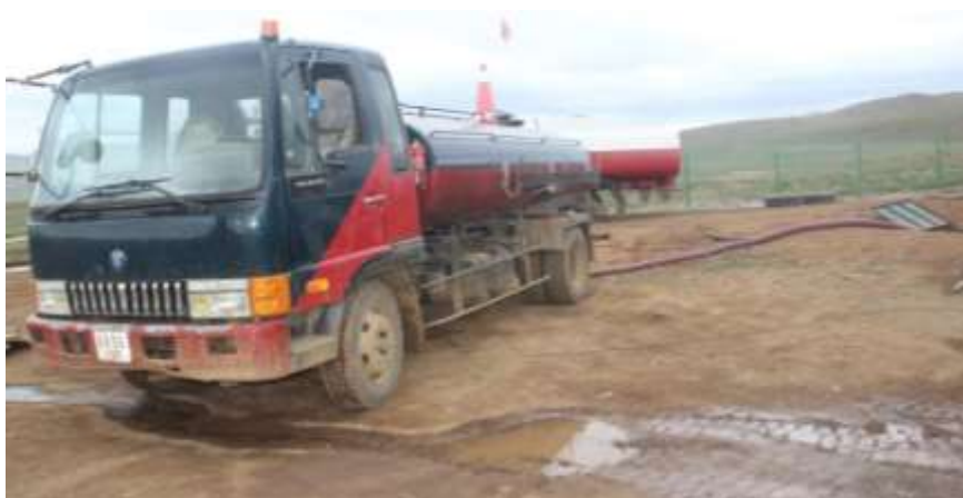
Зураг 34 Ахуйн шингэн хаягдал соруулж буй байдал
