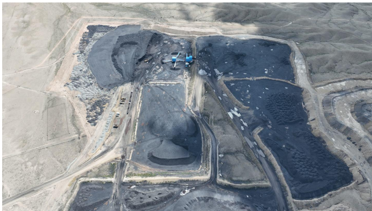
Зураг 5. Нүүрсний өөрөө ноцолт хянах дроны мониторинг
