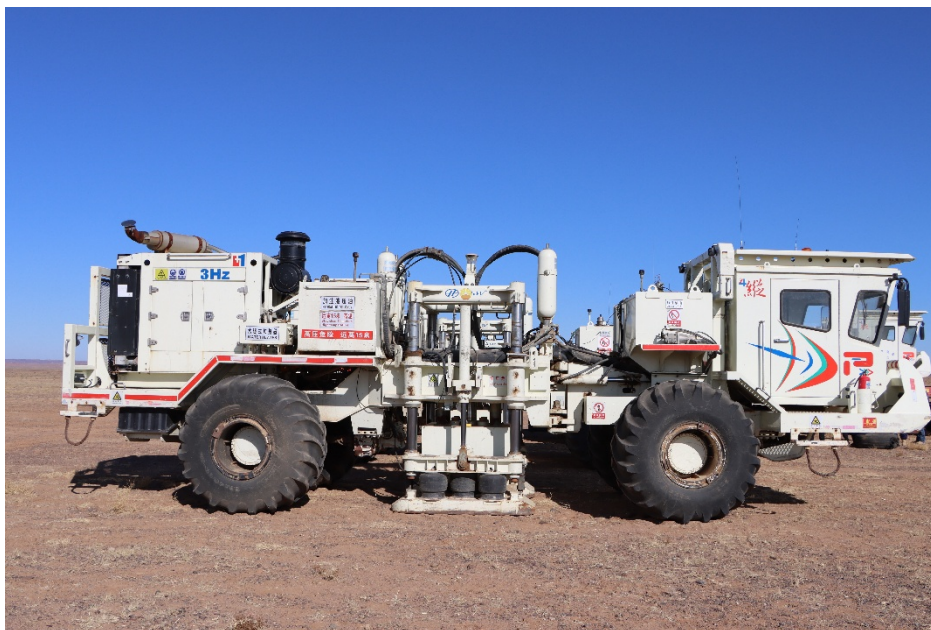
Зураг 3. Вибраторын машин уян харимхай долгион үүсгэж буй нь
