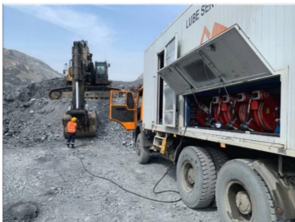
Зураг-2.10. Тосолгооны машин карьерт үйлчилгээ хийж буй байдал.
