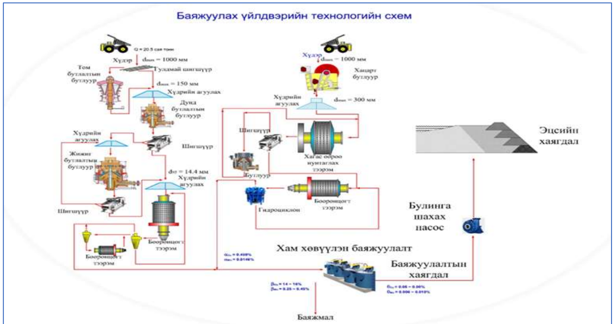
Зураг 17. Баяжуулах үйлдвэрийн технологийн схем
