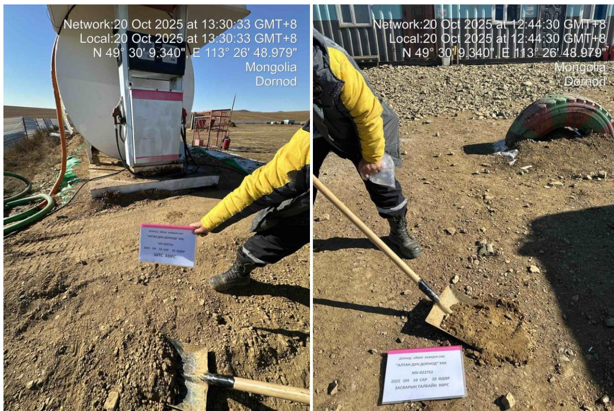
Зураг № 16 ШТС-ын талбай, Засварын талбайгаас хөрсний дээж авч буй байдал
