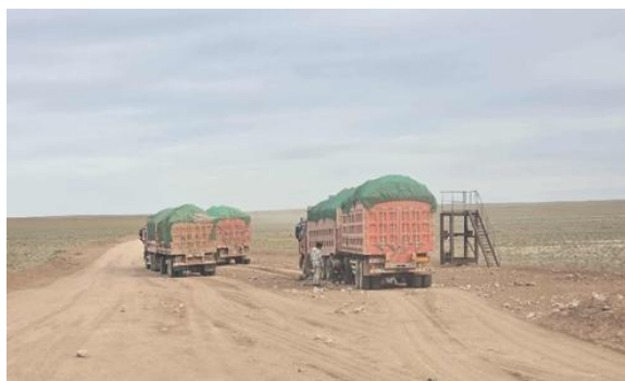
Зураг 11. Гөлтгөнө тээврийн машинуудын түүхий эд хучилтын талбайд зориулалтын бүтээлэг ашиглаж буй үйл явц
