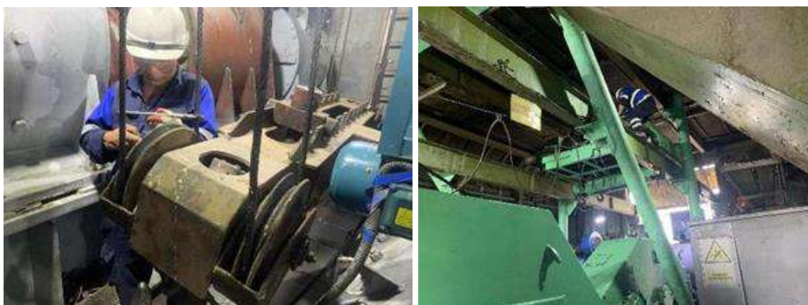
Зураг 33. “Өргөх машин ХХК”-ний Засварын ахлах механик Н. Пүрэвцоодол, механик Өсөхжаргал нар Уурхайн бүх хэсэг нэгжид байрладаг. Сумт, гүүрэн, гинжит, өөрөө явагч 10 кранд техникийн бүрэн бүтэн байдал, ажиллагааныхэвийн байдал, хөдөлгөгч эд ангиудын бүрэн бүтэн байдал, холхивч, втулка, тросс зэргийн элэгдлүүд болон суналт зэрэгт үзлэг оношлогоо хийж, крануудад хийгдэх шаардлагатай засвар, үйлчилгээний талаар зөвлөмж өгч, краны магадлагааг иж бүрэн хийж, баталгаажуулсан болно.
