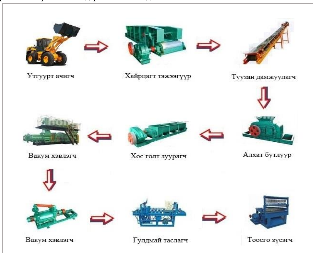
Зураг 2. Тоосго үйлдвэрлэлийн тоног төхөөрөмжийн дамжлага схем
