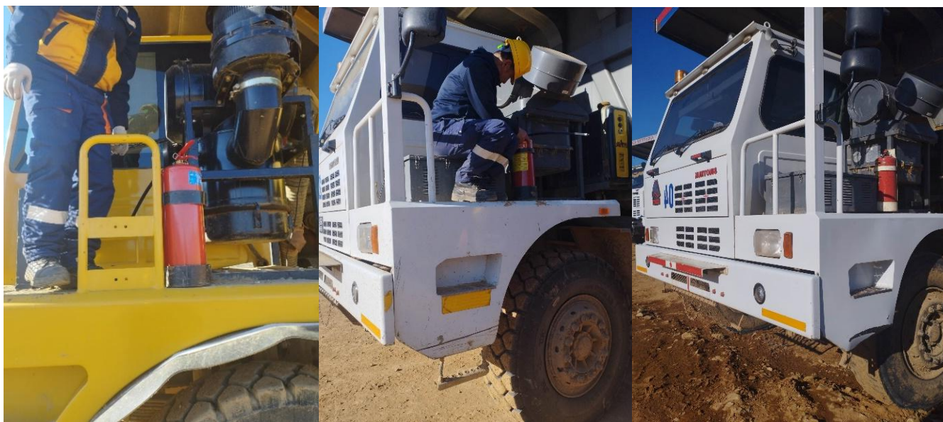
Зураг.34 Автосамсвалдуудад галын хор байруулсан байдал
