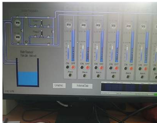
Зураг 3. Үйлдвэрийн усан сан, насос станцын хяналтын самбар
