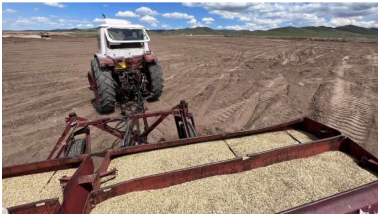
Зураг 23 Үрэлгээ хийсэн трактор болон үрийн холимог жигд урсаж буй байдал
