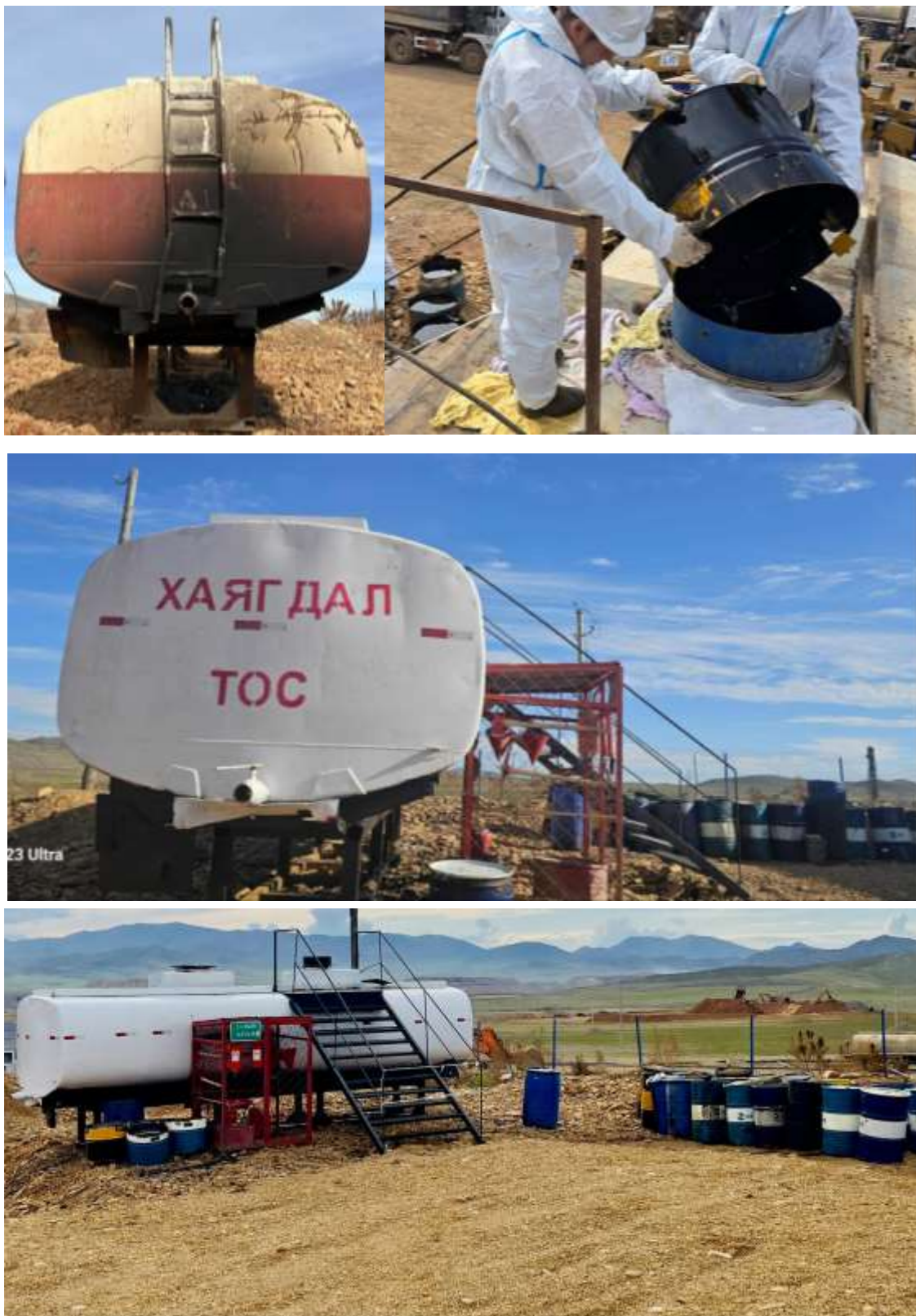
Зураг 41 Хаягдал тосыг ёмжсөт түр хуримтлуулан аюулгүй байдал ханган ажиллаж байна
