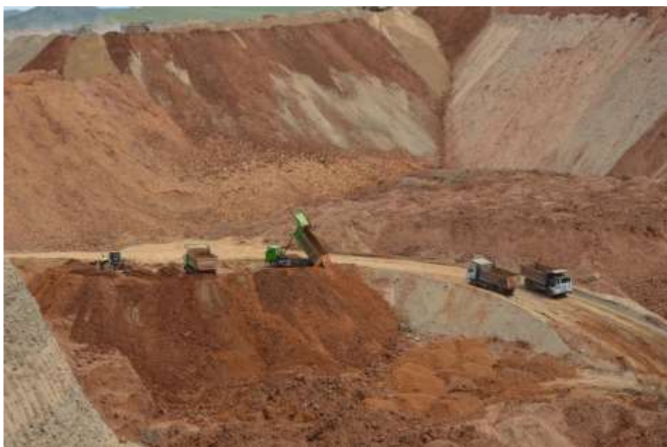
Зураг 20 Дотоод овоолго үүсгэх замаар нөхөн сэргээлтийн ажил хийгдэж буй байдал
