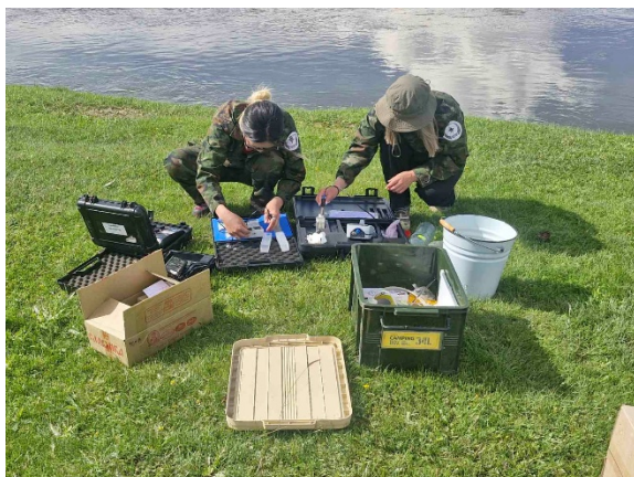
Зураг 23. Усны шинжилгээ. Тэсийн голын TG-2 цэгт хүчилтөрөгч, рН, булингар тодорхойлох үе
