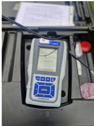
Зураг 23. Усны шинжилгээ. Тэсийн голын TG-2 цэгт хүчилтөрөгч, рН, булингар тодорхойлох үе
