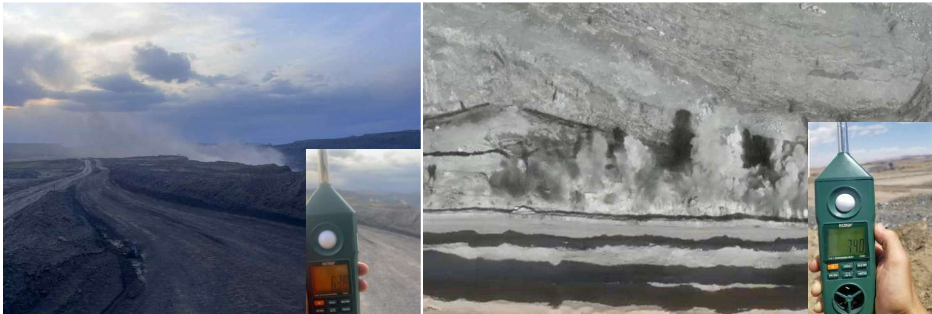
Зураг 63. Тэсэлгээний явцад 500 метр зайнаас дуу чимээг зөөврийн багажаар хэмэжн дроноор бичлэгийг хийж гүйцэтгэж буй байдал
