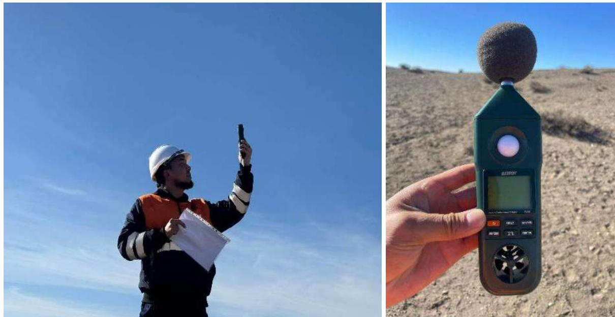
Зураг 46. Дуу шуугиан агаарын хэм, харьцангуй чийгишлийн хэмжилт хийж буй байдал
