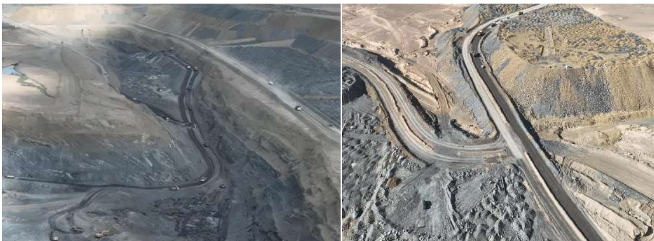
Зураг 3. Уурхайн олборлолтын үед тоосжилт бууруулах зорилгоор усалгаа хийгдсэн байдал
