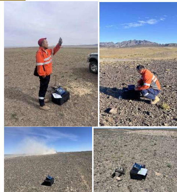
Зураг 49. Нүүрс тээврийн замын тоосны хэмжилтийн цэгүүд харуулсан план болон нүүрс тээврийн зам дагуух 4 цэгт тоосны хэмжилт хийж буй байдал
