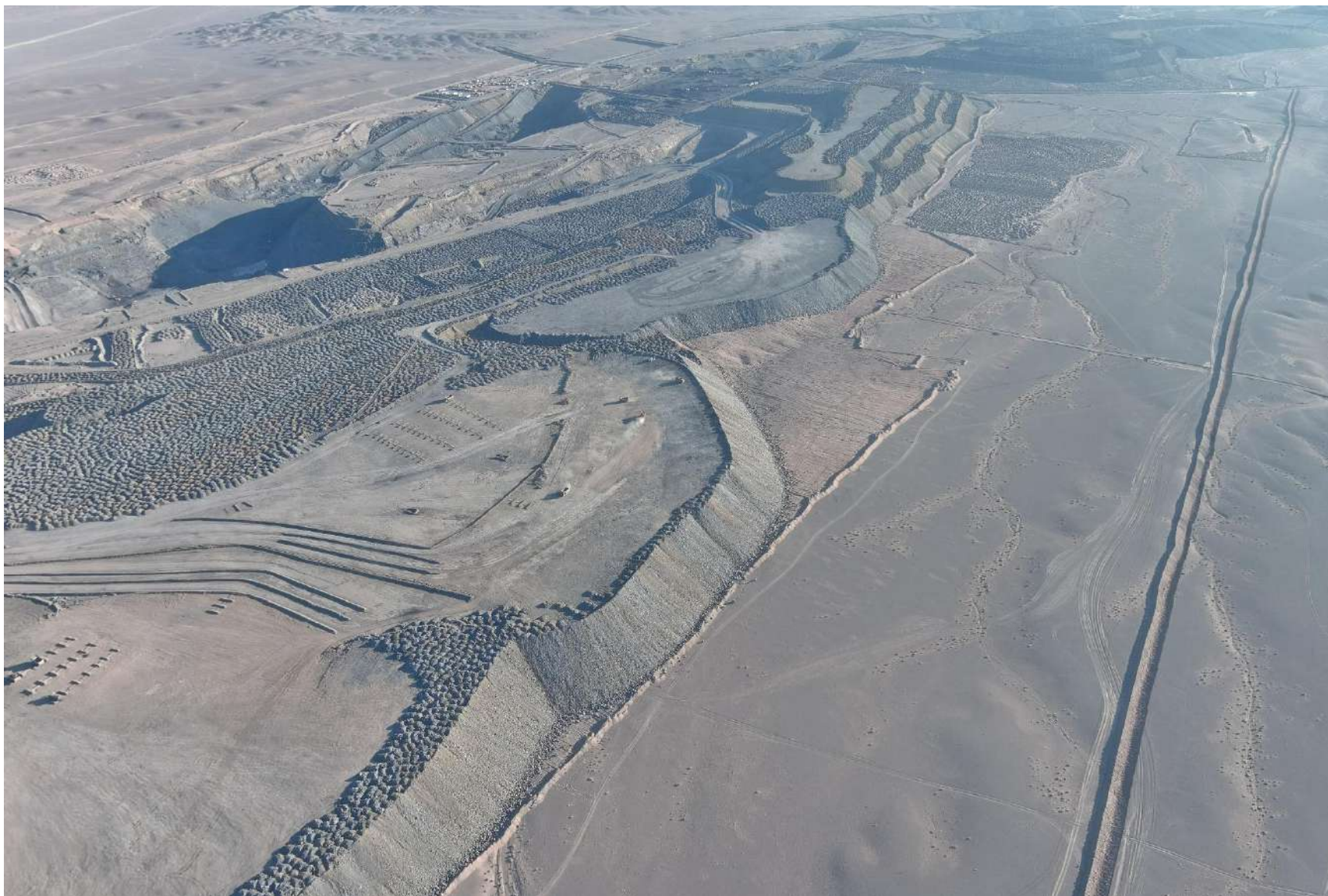
Зураг 17. Хаягдлын овоолгийн тэлэлт болон шимт хөрс хуулалт, хадаглалтыг бүхэлдээ харагдаж буй байдал
