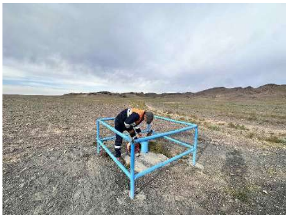
Зураг 54. Уурхайн усны хяналтын цэгийн усны түвшний үр дүнгийн график болон усны түвшний хэмжилт хийж буй
