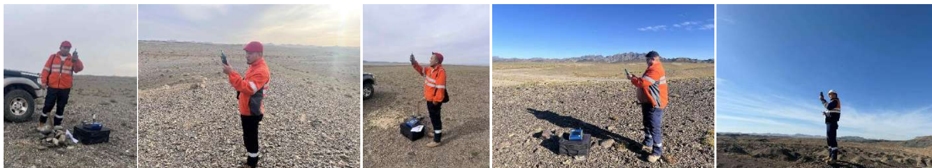
Зураг 51. Дуу чимээг зөөврийн багажаар хэмжиж буй байдал
