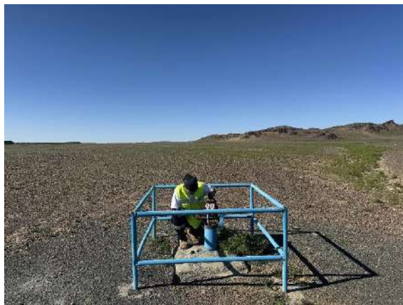
Зураг 54. Уурхайн усны хяналтын цэгийн усны түвшний үр дүнгийн график болон усны түвшний хэмжилт хийж буй
