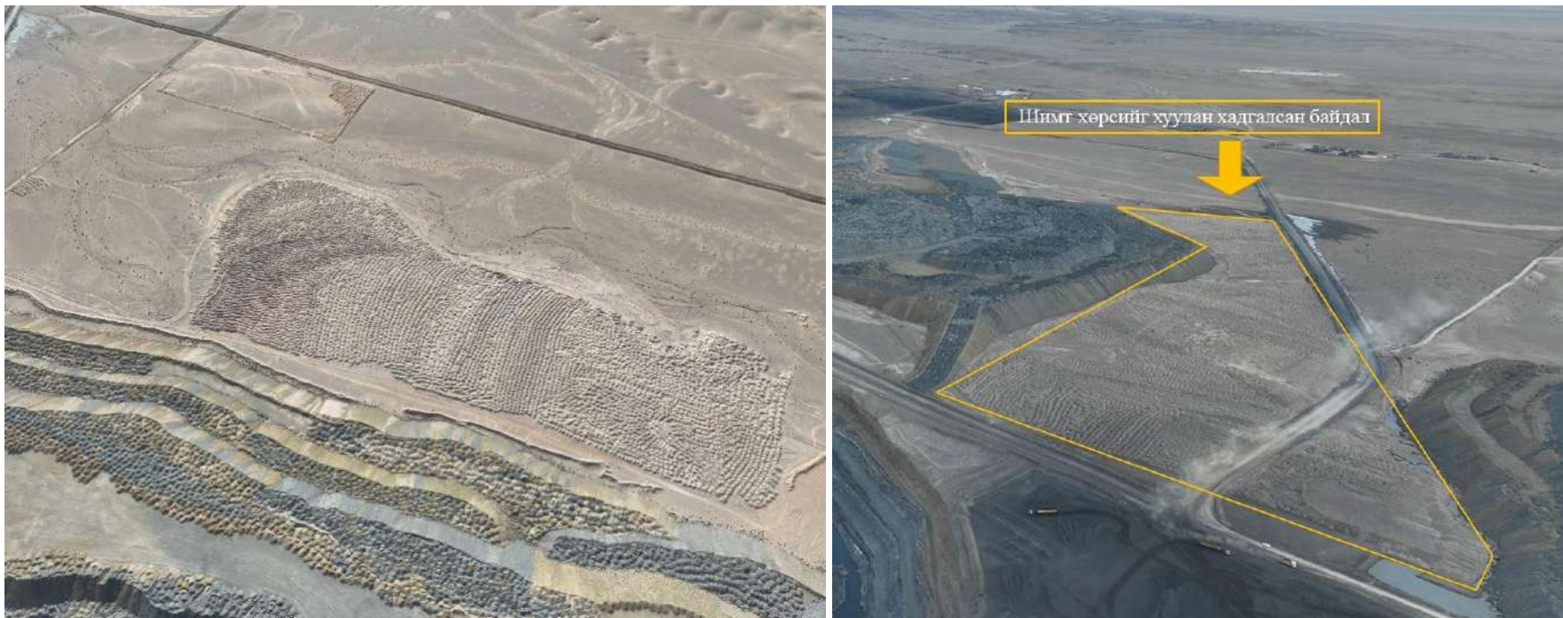
Зураг 16. . Шимт хөрсийг хуулан хадгалсан байдал /2025 онд хөрсний овоолгийн тэлэлтээс гарсан шимт хөрсийг шимт хөрсний овоолгуудад хуулан байршуулсан байдал/
