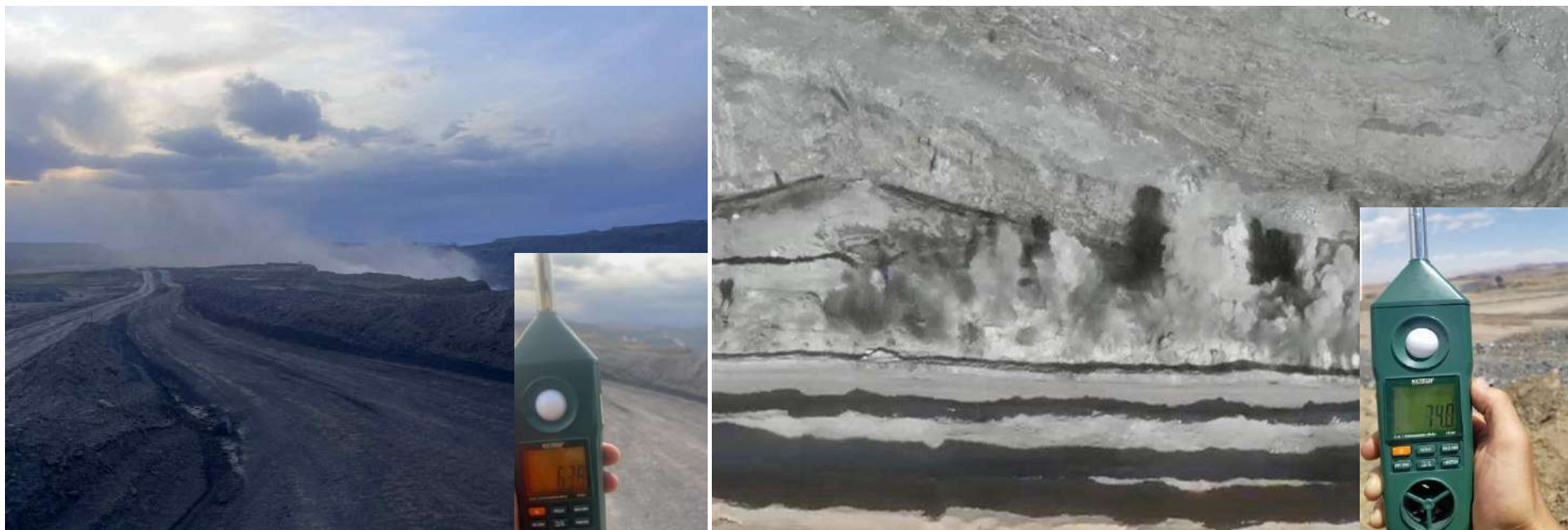
Зураг 52. Тэсэлгээний явцад 500 метр зайнаас дуу чимээг зөөврийн багажаар хэмэжсн дроноор бичлэгийг хийж гүйцэтгэж буй байдал
