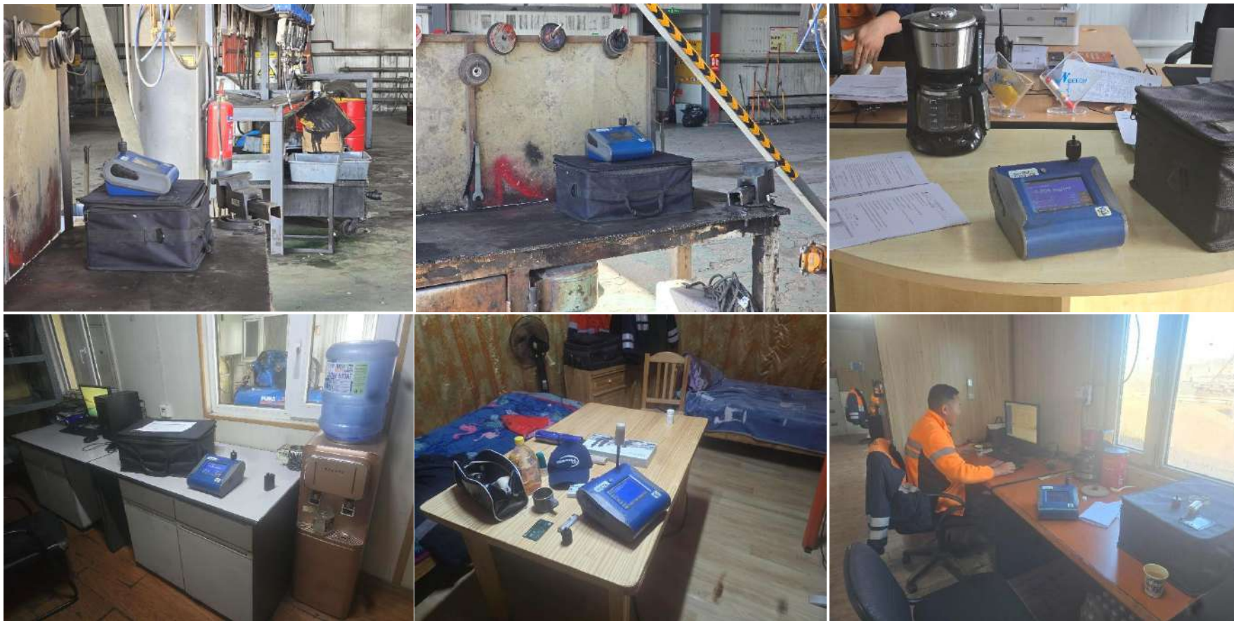
Зураг 4. Уурхайн дотоод орчин буюу ажлын байрны нарийн болон бүдүүн ширхэгтэй тоосонцорын хэмжилтыг хийжэ буй байдал
